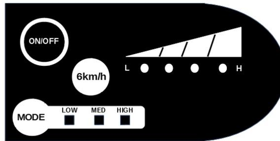
Dlouhým stisknutím červeného tlačítka **ON/OFF** (*nahoře, vlevo*) zapnete napájení motoru elektrokola. Krátkým stisknutím červeného tlačítka **ON/OFF** (*nahoře, vlevo*) vypnete napájení motoru elektrokola.
