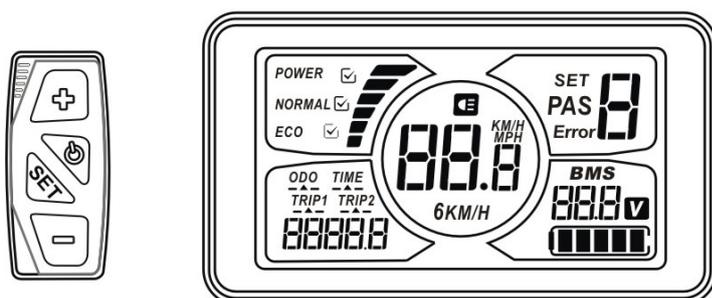
Krátkým stisknutím tlačítka
