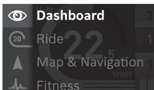
Naciskając joystick **1** w lewo, można wyświetlić Menu główne, które nałoży się na aktualnie wyświetlany tryb (zob. rys. powyżej).
