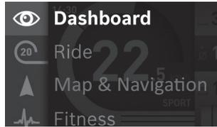
Valdymo svirtelę **1** palenkę kairėn, aktyvaus veikimo režimo langą galite perdengti pagrindinio meniu langu ir perjungti į pagrindinį meniu (žr. pav. viršuje).
