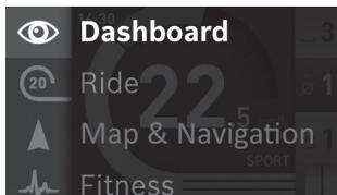
Cu joystick-ul **1**, prin apăsare și împingere spre stânga, puteți estompa modul de funcționare activ, acoperindu-l cu meniul principal și schimba în meniul principal (vezi imaginea de sus).
