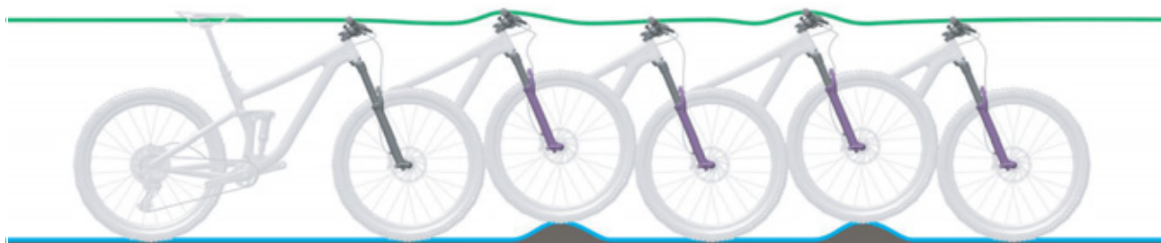
Obr. 113: Optimální chování vidlice při jízdě
