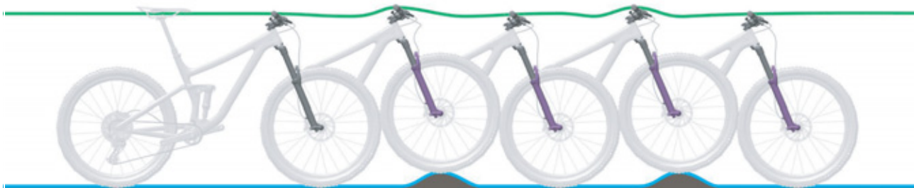
Obr. 11: Optimální chování vidlice při jízdě
