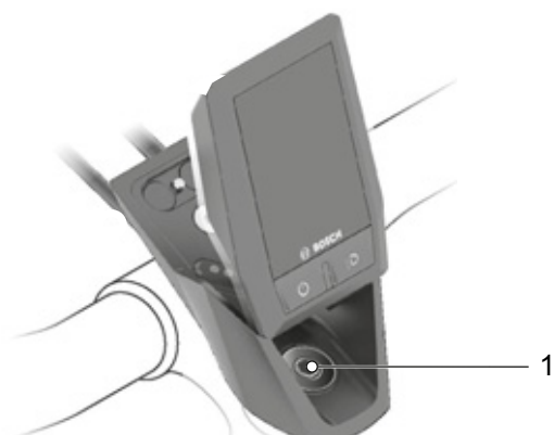
Obr. 125: Umístění šroubu hlavního složení
