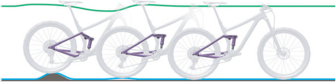
Obr. 232: Příliš rychlé roztahování tlumiče zadního odpružení
