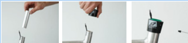
Obr. 219: Montáž kluzného pouzdra a vnějšího pouzdra
