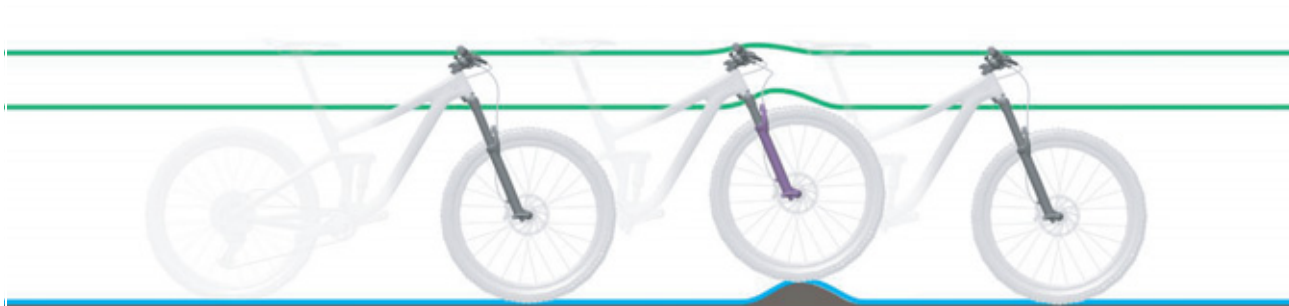
Obr. 10: Optimální chování vidlice při jízdě u nerovností
