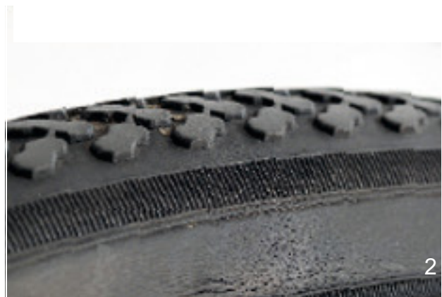
Obr. 150: Příklady únavových trhlin (1) a trhlin vzniklých stárnutím (2)
