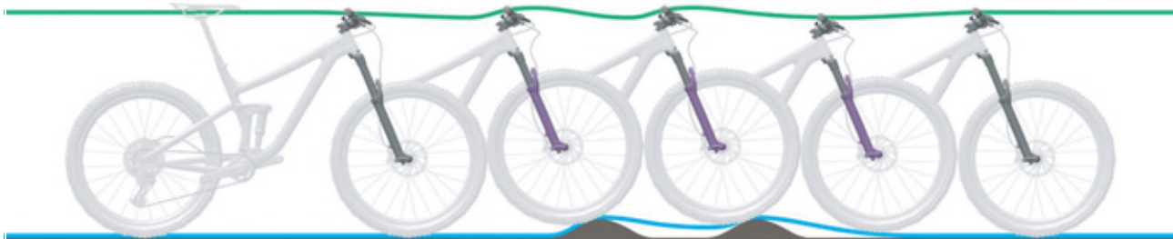
Obr. 226: Příliš pomalé roztahování odpružené vidlice
