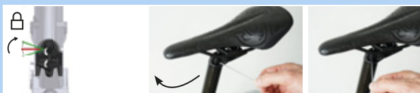
Obr. 199: Zavření nastavení výšky
