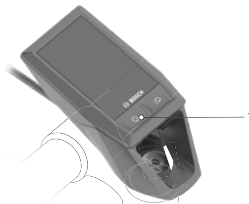
Obr. 138: Poloha vypínače (ovládací jednotka)
