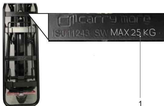
Obr. 134: Na nosiči zavazadel je uvedena jeho maximální nosnost (1)
