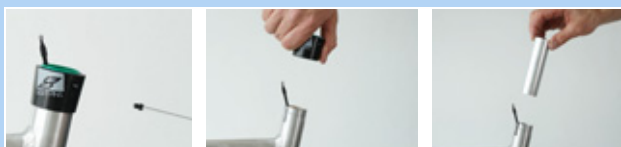
Obr. 170: Demontáž vnějšího pouzdra a kluzného pouzdra
