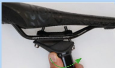
Obr. 213: Otevření nastavení výšky
