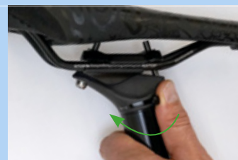
Obr. 218: Zavření nastavení výšky
