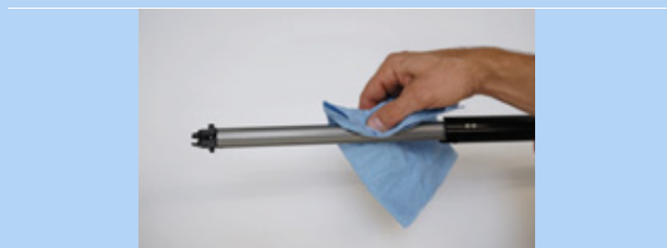
Obr. 200: Očištění podélné vodicí drážky
