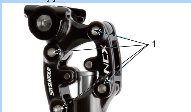
Obr. 146: Mazací body odpružené sedlovky Suntour SR
