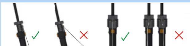
Obr. 174: Správné a nesprávné vedení bovdenů
