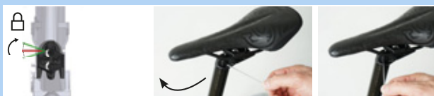
Obr. 184: Zavření nastavení výšky
