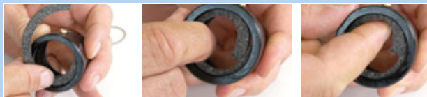
Obr. 195: Vložení plstěného kroužku
