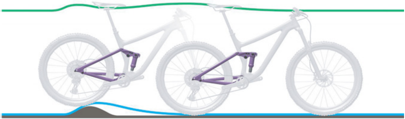
Obr. 223: Příliš tvrdé tlumení tlumiče zadního odpružení u nerovností
