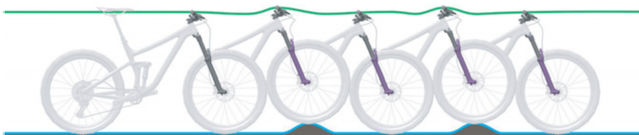
Obr. 98: Optimální chování vidlice při jízdě
