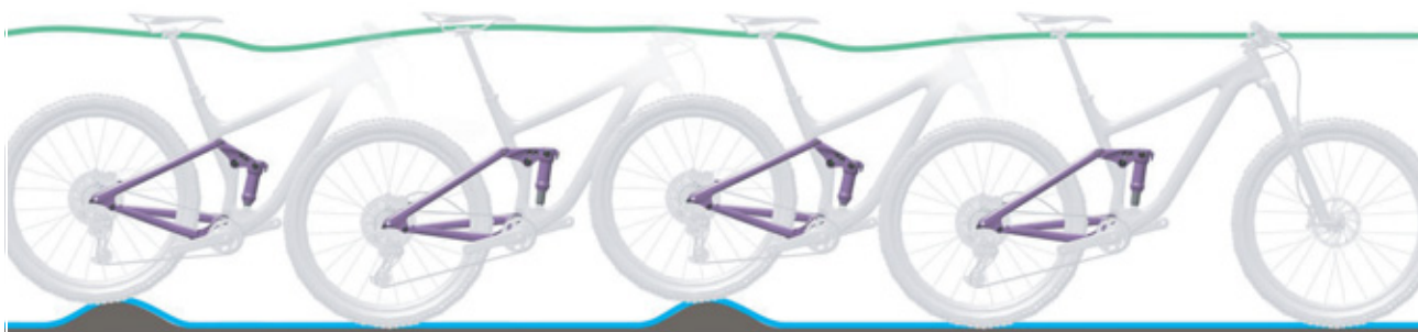
Obr. 15: Optimální chování tlumiče zadního odpružení při jízdě
