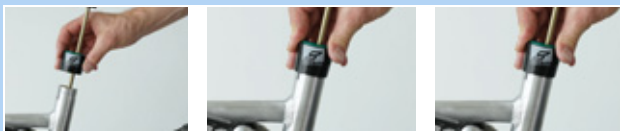
Obr. 179: Nasazení vnějšího pouzdra
