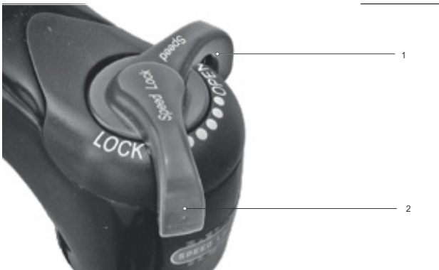
Obr. 216: Měkké nastavení nastavovacího šroubu komprese
