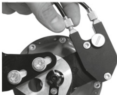
Obr. 140: Náboje Rohloff s externím ovládáním řazení mají seřizovače napnutí na lanovodu, který je umístěn na levé straně
