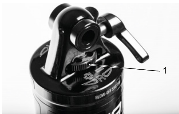
Obr. 220: Nastavovací šroub odskoku Suntour (1) na tlumiči zadního odpružení
