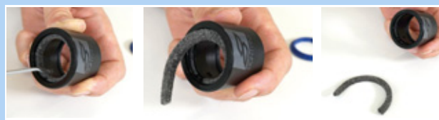
Obr. 158: Odstranění plstěného kroužku
