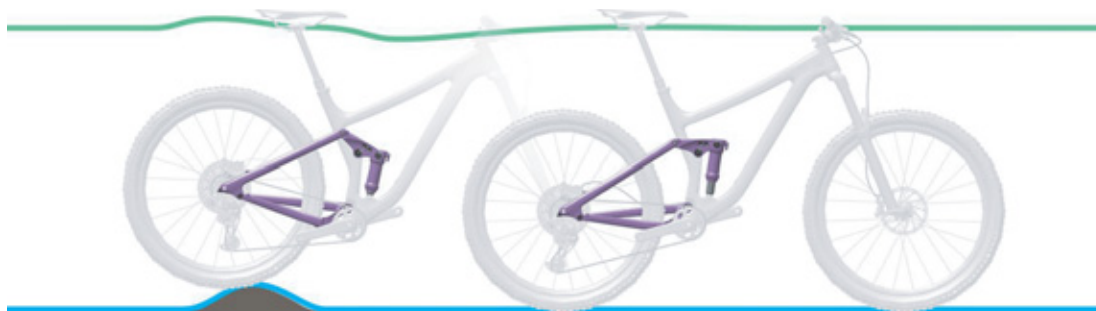
Obr. 17: Optimální chování tlumiče zadního odpružení při jízdě u nerovností
