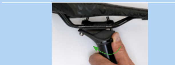
Obr. 203: Zavření nastavení výšky
