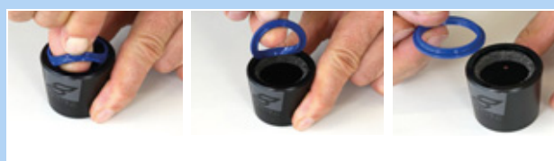
Obr. 157: Vytažení stíracího kroužku
