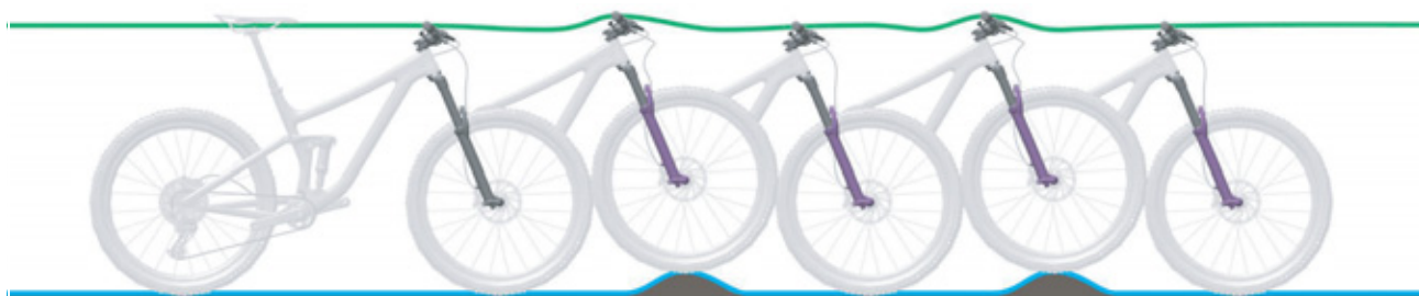
Obr. 11: Optimální chování vidlice při jízdě
