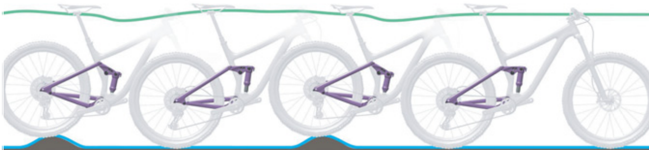
Obr. 19: Optimální chování tlumiče zadního odpružení při jízdě
