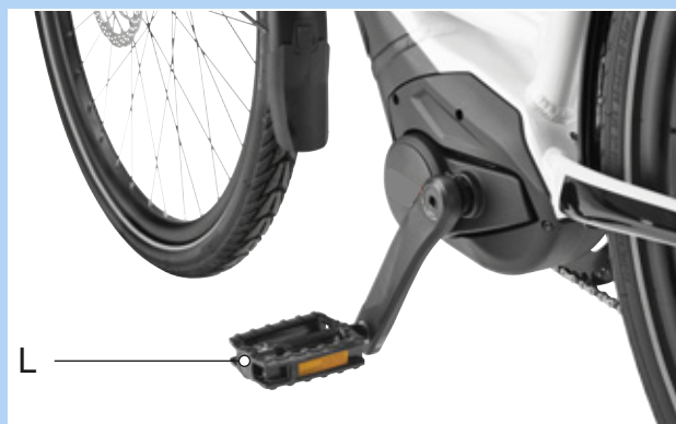
Obr. 67: Pedál L levého ramena kliky
