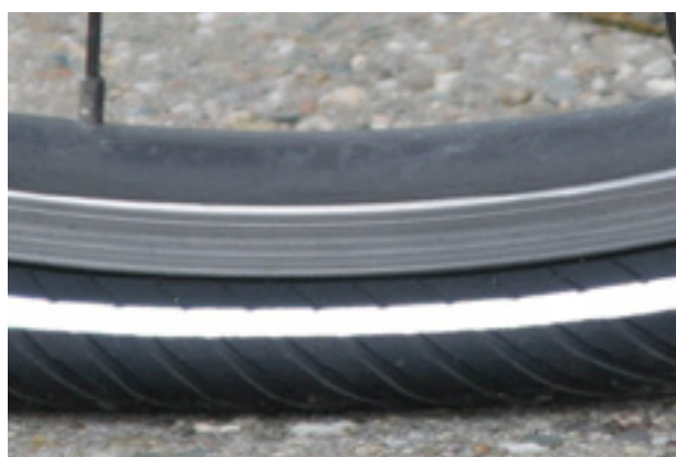
Obr. 95: Příliš nízký tlak
