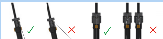
Obr. 194: Správné a nesprávné vedení bovdenů
