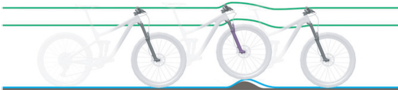
Obr. 235: Příliš tvrdé tlumení odpružené vidlice u nerovností
