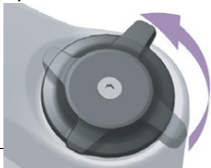
Obr. 146: Měkké nastavení nastavovacího šroubu komprese
