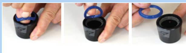
Obr. 202: Vytažení stíracího kroužku
