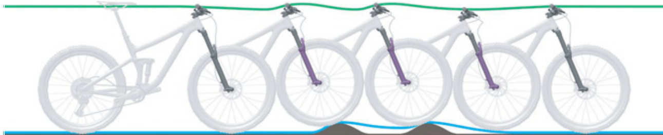
Obr. 264: Příliš pomalé roztahování odpružené vidlice
