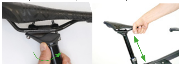
Obr. 95: Nastavení výšky sedlovky
