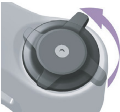
Obr. 269: Měkké nastavení nastavovacího šroubu komprese
