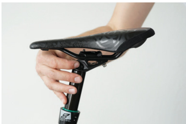
Obr. 102: Nastavení sklonu sedla na nastavovacím kolečku
