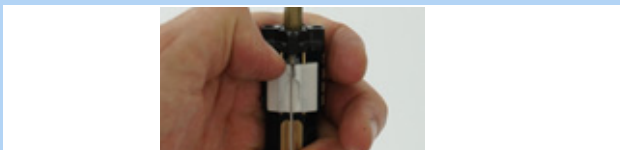
Obr. 218: Posunutí bílého ovládacího šoupátka dolů
