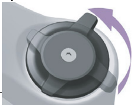
Obr. 172: Měkké nastavení nastavovacího šroubu komprese
