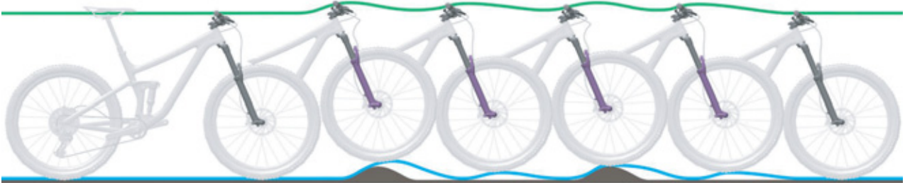
Obr. 262: Příliš rychlé roztahování odpružené vidlice
