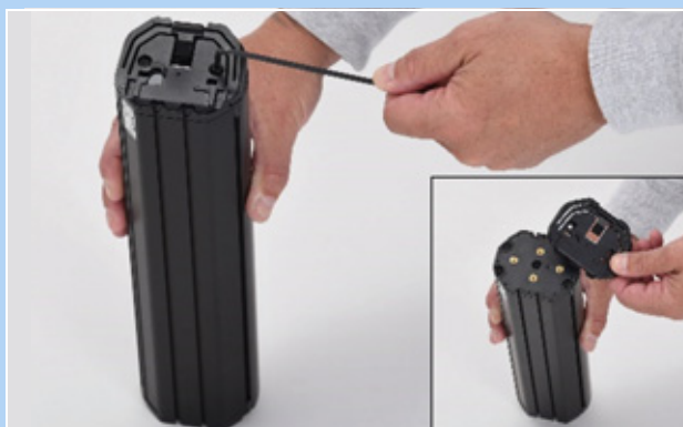
Obr. 64: Demontáž horního rozhraní
