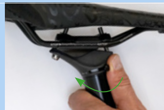
Obr. 248: Zavření nastavení výšky
