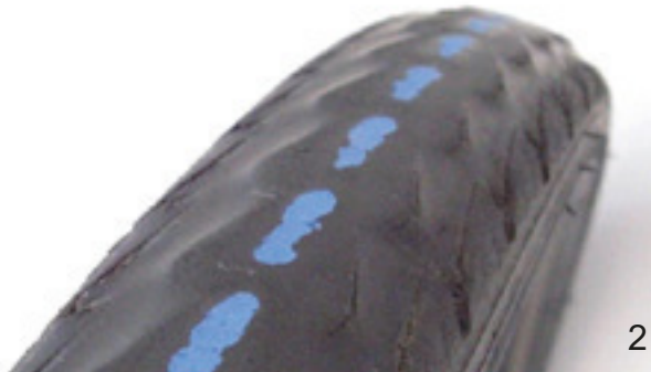
Obr. 179: Pneumatika bez běhounu, na které lze ještě jezdit (1), a pneumatika s proraženou ochranou (2), kterou je třeba vyměnit
