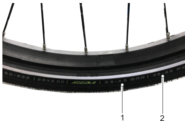
Obr. 178: Plnicí tlak v barech (1) a psi (2)
