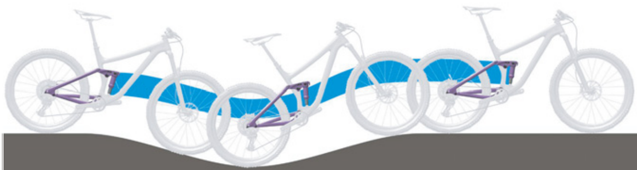
Obr. 17: Optimální chování tlumiče zadního odpružení při jízdě v kopcovitém terénu
