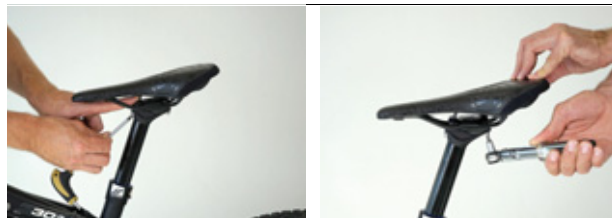
Obr. 100: Utažení předních a zadních šroubů
