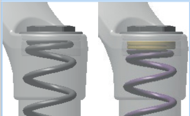
Obr. 137: Otáčení nastavovacím kroužkem předpětí dovnitř a ven
