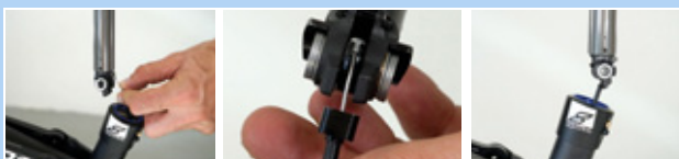
Obr. 250: Zavedení a zasunutí sedlovky
