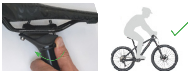
Obr. 96: Utažení osy sedlovky
