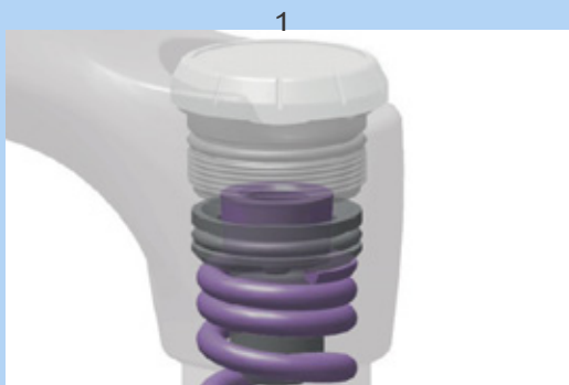
Obr. 128: Otáčení nastavovacího kroužku předpětí dovnitř a ven
