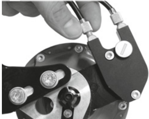
Obr. 185: Náboje Rohloff s externím ovládním řazení mají seřizovače napnutí na lanovodu, který je umístěn na levé straně
