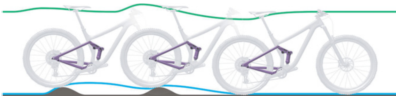
Obr. 272: Příliš pomalé roztahování tlumiče zadního odpružení
