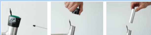
Obr. 234: Demontáž vnějšího pouzdra a kluzného pouzdra
