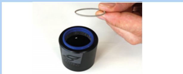
Obr. 201: Vyjmutí pružné podložky
