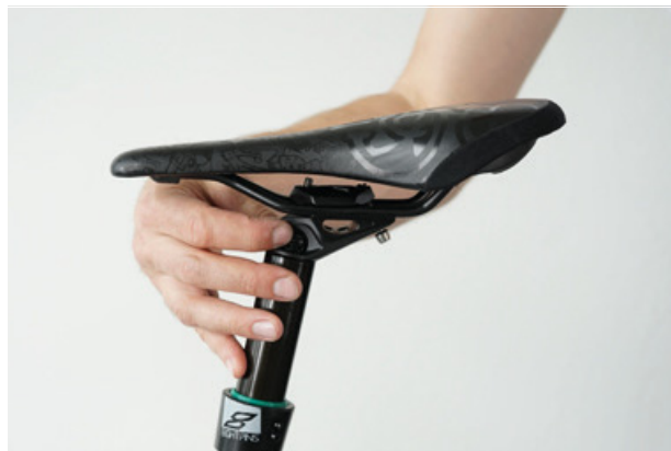
Obr. 106: Nastavení sklonu sedla na nastavovacím kolečku
