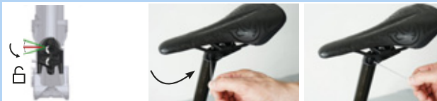
Obr. 192: Přesuňte ovladač nastavení výšky do polohy „Otevřeno“
