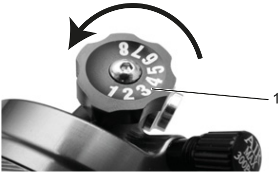
Obr. 275: Nastavovací šroub komprese Suntour (1) na tlumiči zadního odpružení
