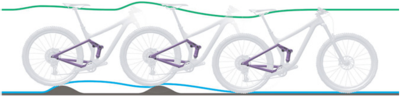
Obr. 280: Příliš pomalé roztahování tlumiče zadního odpružení
