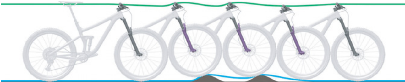
Obr. 209: Příliš pomalé roztahování odpružené vidlice
