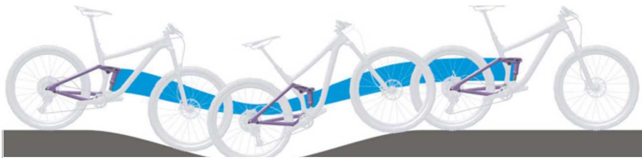
Obr. 229: Příliš měkké odpružení tlumiče zadního odpružení v horách
