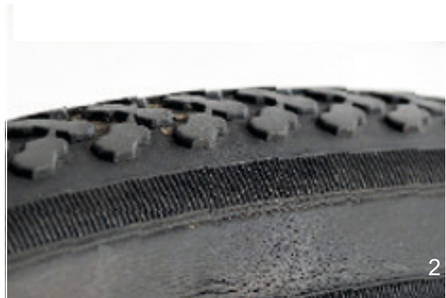
Obr. 133: Příklady únavových trhlin (1) a trhlin vzniklých stárnutím (2)
