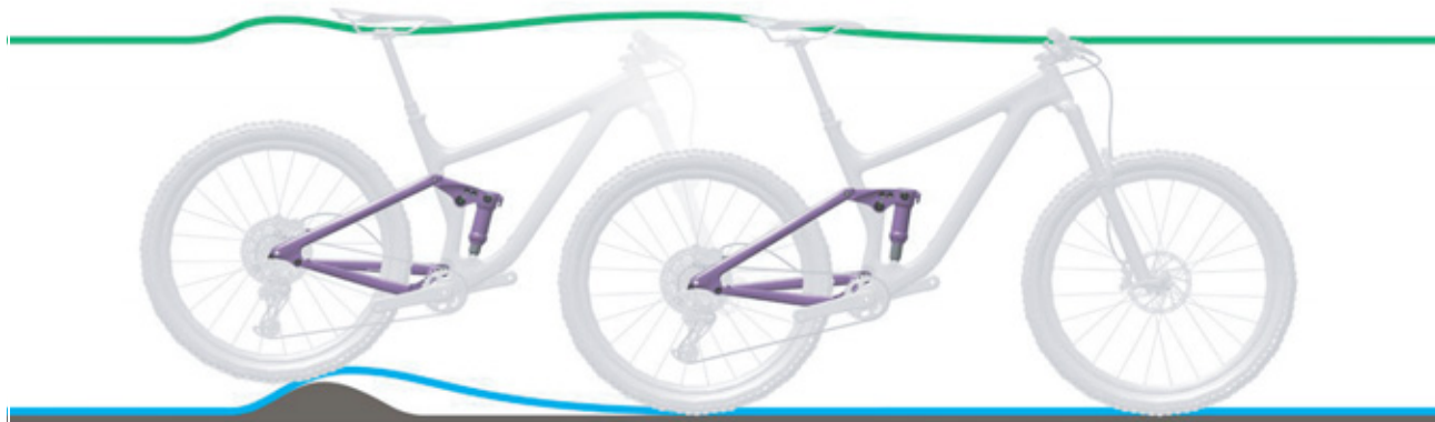
Obr. 231: Příliš tvrdé tlumení tlumiče zadního odpružení u nerovností
