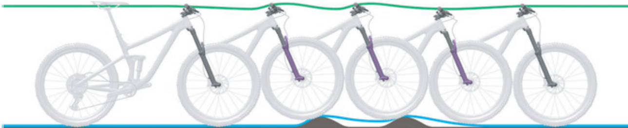
Obr. 217: Příliš pomalé roztahování odpružené vidlice
