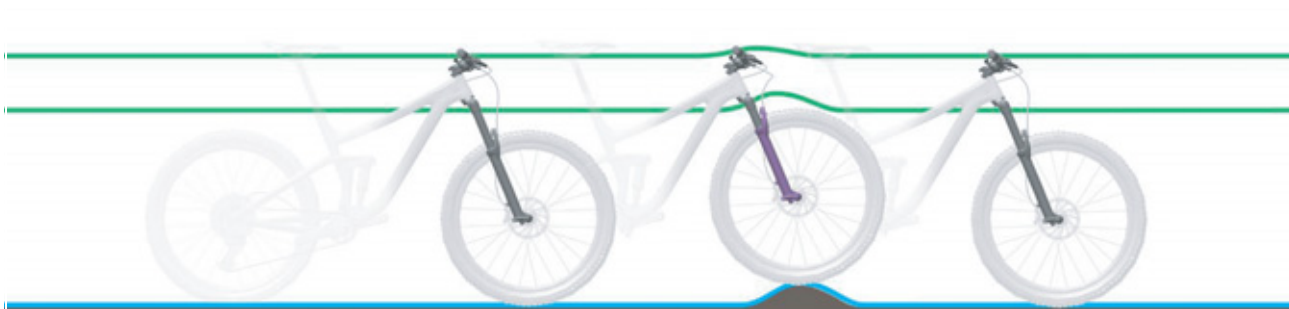
Obr. 10: Optimální chování vidlice při jízdě u nerovností
