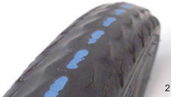
Obr. 132: Pneumatika bez běhounu, na které lze ještě jezdit (1), a pneumatika s proraženou ochranou (2), kterou je třeba vyměnit
