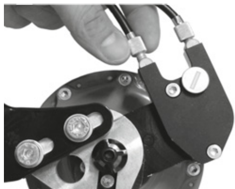
Obr. 138: Náboje Rohloff s externím ovládním řazení mají seřizovače napnutí na lanovodu, který je umístěn na levé straně
