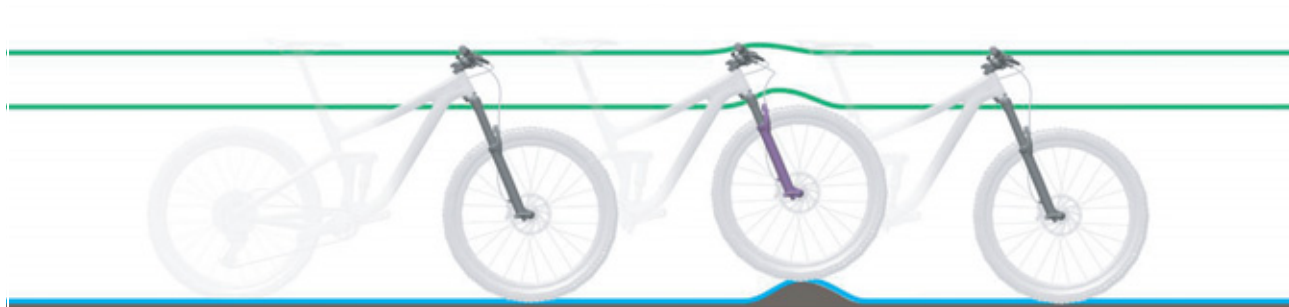
Obr. 120: Optimální chování při jízdě u nerovnosti
