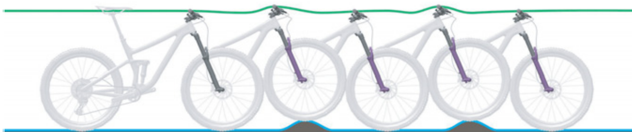
Obr. 93: Optimální chování vidlice při jízdě
