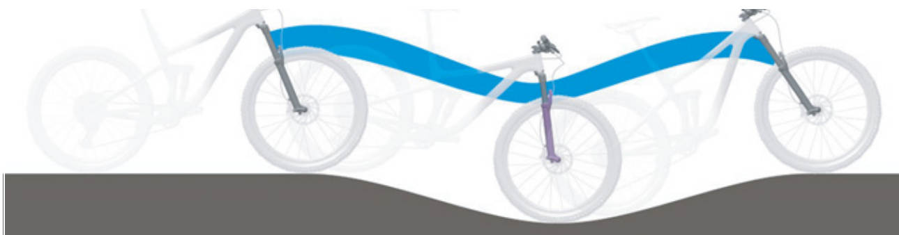
Obr. 9: Optimální chování vidlice při jízdě v kopcovitém terénu
