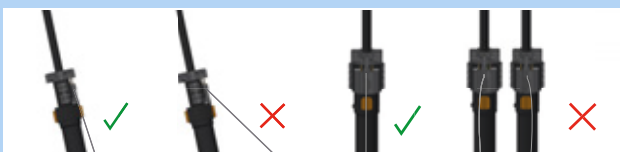
Obr. 172: Správné a nesprávné vedení bovdenů
