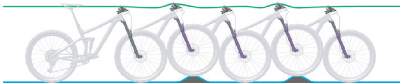
Obr. 11: Optimální chování vidlice při jízdě
