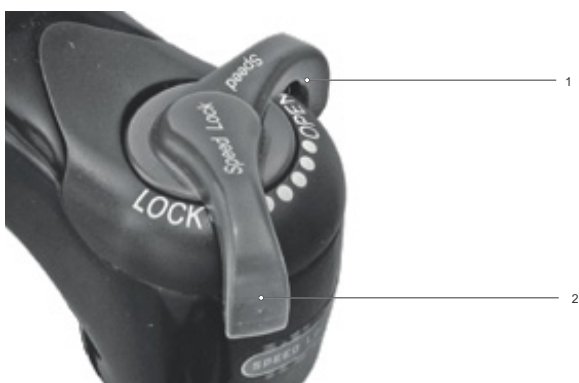
Obr. 202: Tvrdé nastavení nastavovacího šroubu komprese
