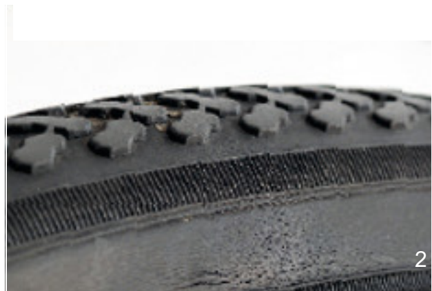
Obr. 163: Příklady únavových trhlin (1) a trhlin vzniklých stárnutím (2)
