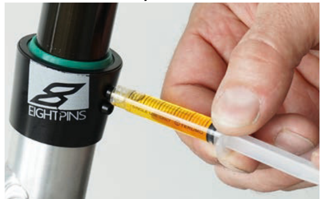
Obr. 160: Namazání sedlovky eightpins
