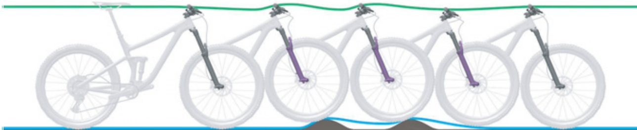
Obr. 199: Příliš pomalé roztahování odpružené vidlice
