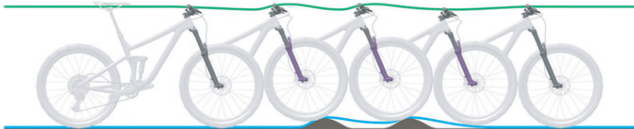
Obr. 211: Příliš pomalé roztahování odpružené vidlice
