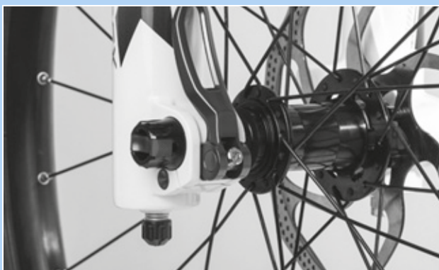
Obr. 144: Nastavení upínací síly rychloupínáku
