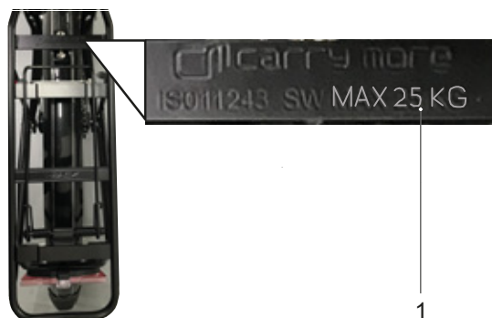
Obr. 115: Na nosiči zavazadel je uvedena jeho maximální nosnost (1)
