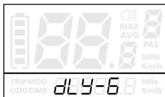
Rozhraní pro dobu prodlevy bateriového napájení
