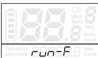
Nastavení směru senzoru PAS
